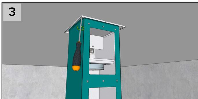
Monter opp pipedelen i henhold til separat monteringsanvisning.
