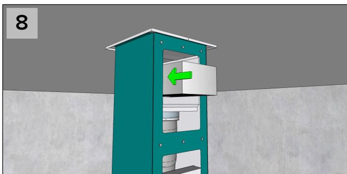
Stapp kullfilterkassetten inn i luftsprederen.
