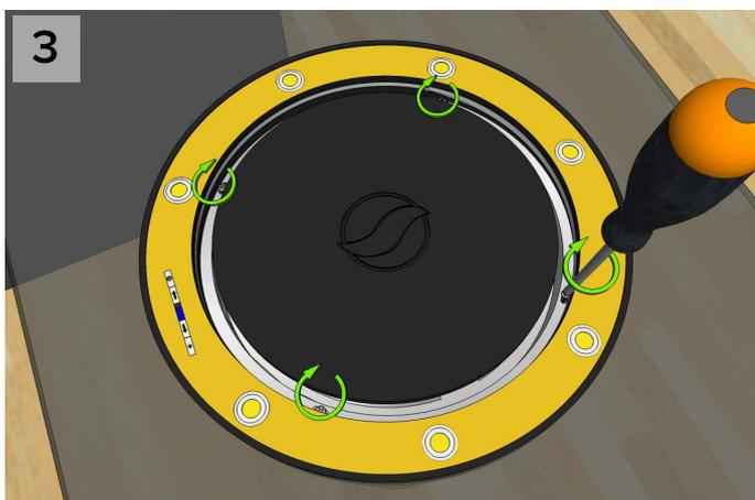
Skru løs skruene som er formontert i pipens underkant. Stapp forsiktig piperøret ned i uttaket på komfyrhettens overside. Drei pipen rett, slik at innfestingshullene er rettet inn etter pressmutterne i pipens underkant.
