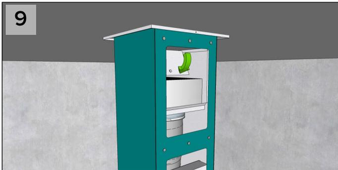
Monter avtrekksgitteret på pipen.
