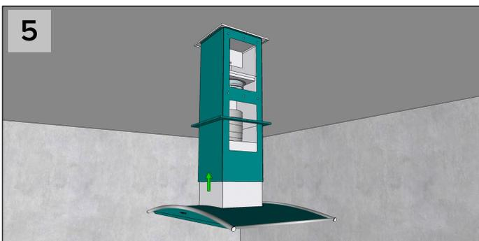
Monter opp komfyrretten i henhold til separat monteringsanvisning. Slipp ved behov skruene som holder luftsprederen på plass, når du kobler til strømmen.
