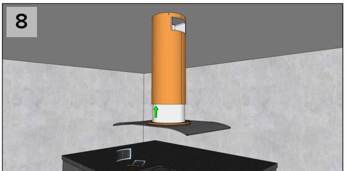
Løft opp komfyrheten og monter fast i piperøret i henhold til separat monteringsanvisning.
