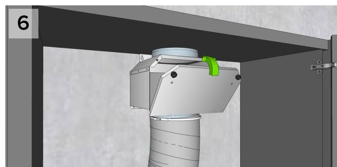
Stapp kullfilterkassetten inn i luftsprederen.
