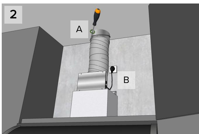
Monter fast trommelsettet (A) på ventilasjonskanalen med slangeklemmen. Trykk kaldrasbeskyttelsen fast på komfyretts stuss.
