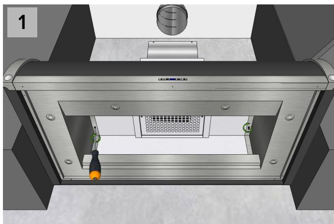
Ta fettfiltrene ut av komfyretts underside, løft den opp mot skapets bunn og skru fast hetten gjennom hullene på undersiden (4 stk.).
