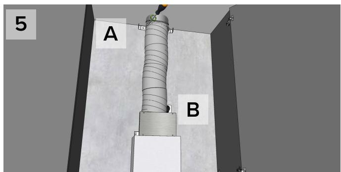
Koble til trommelsettet mellom ventilasjonskanal og hete og fast med slangeklemmer (A).
