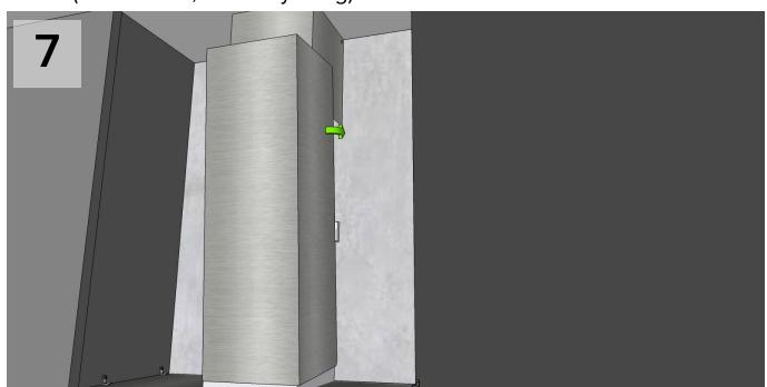
**SUBTIL:** Still den underste pipen på plass. Pipen skal hektes inn bak den øvre pipens bakkant.
