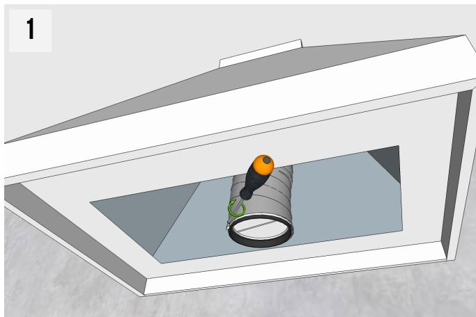
Klargjør trommelsettet, slik at slangen har rett lengde. Slangen bør gå ned til hettens underside.
