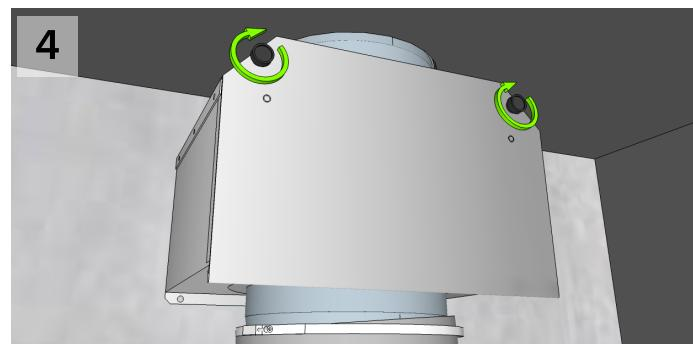
Skru fast avtrekksgitteret oppå skapet.
