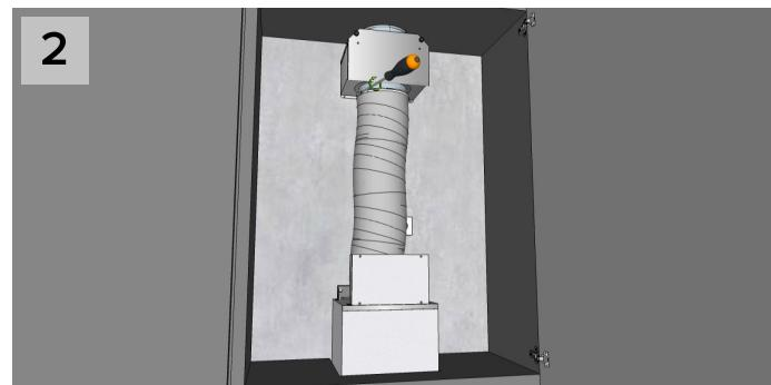
Sag et rundt hull i skapets lokk, ovenfor luftsprederen (diameter ca. 154 mm). Monter fast luftsprederen høyest opp i skapet slik at stussen stikker opp i hullet.
